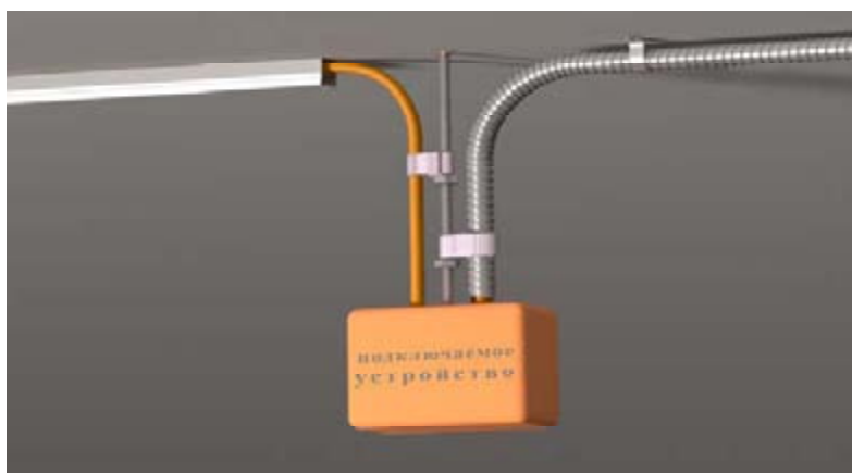
Рис. 7. Пример организации кабельных спусков
