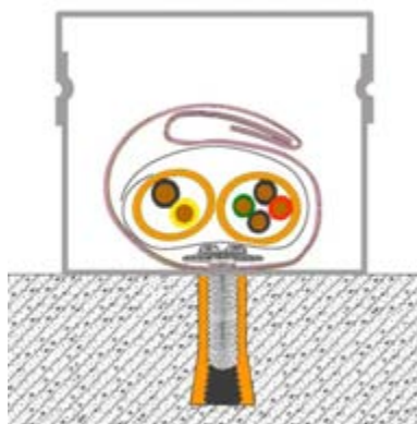
Рис. А.7. Крепление СПЕЦКАБЛАЙН-К2Д крепление с помощью дюбель-хомута
