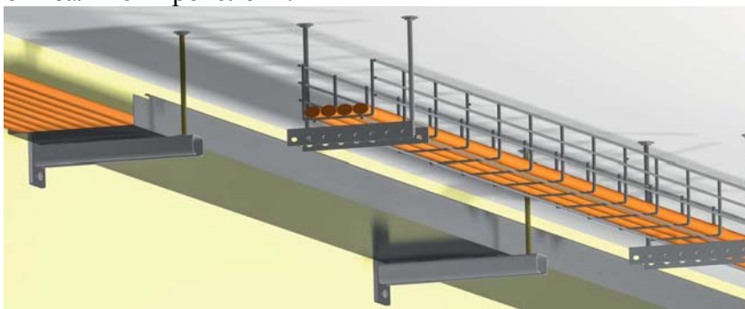
Рис. 7. Пример монтажа ОКЛ СПЕЦКАБЛАЙН-Л.
