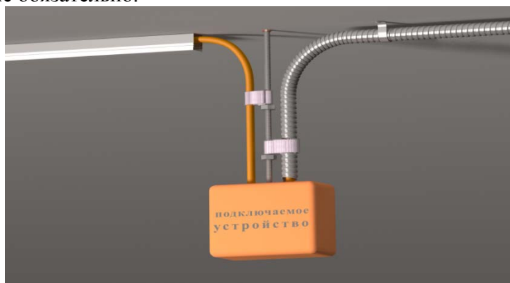
Рис. 16. Пример организации кабельных спусков
