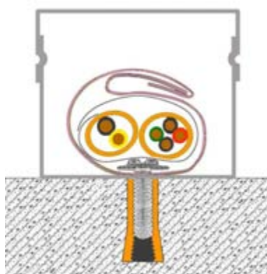
Рис. А.7. Крепление СПЕЦКАБЛАЙН-К2Д крепление с помощью дюбель-хомута
