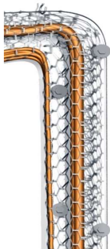
Рис.А.19 Кабельная прокладка «в сетке»
