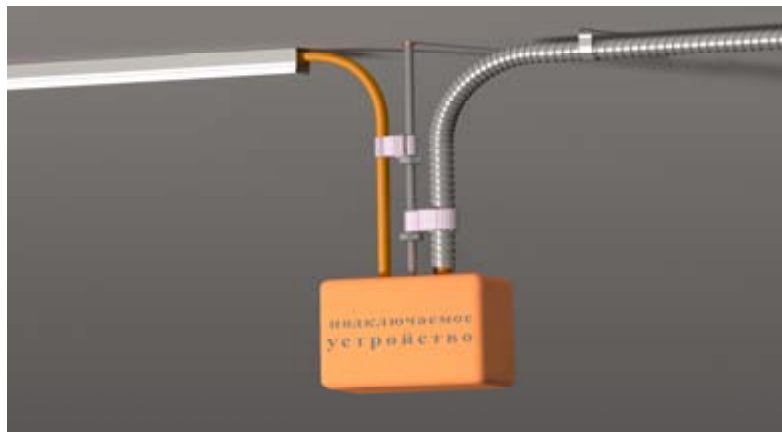
Рис. 10. Пример организации кабельных спусков
